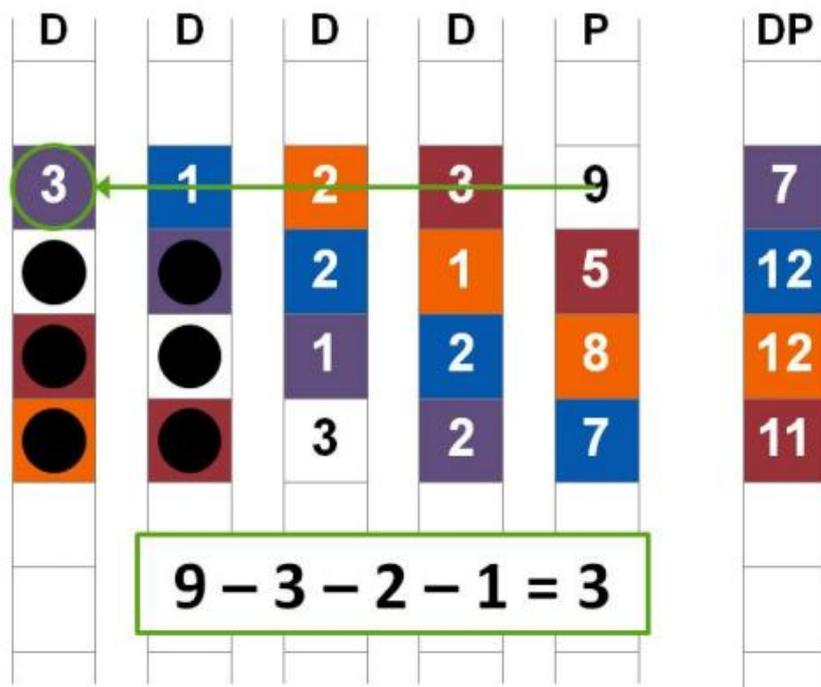
Рис. 6) Восстановление потерянного блока с помощью данных строки блоков.
