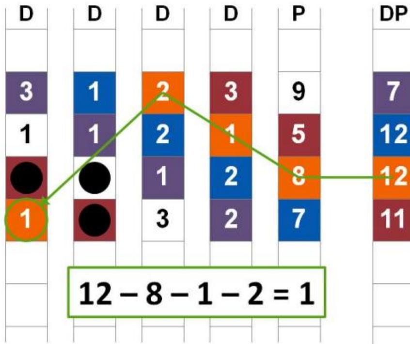
Рис. 9) Восстановление «оранжевого» блока с помощью данных диагонали блоков.
