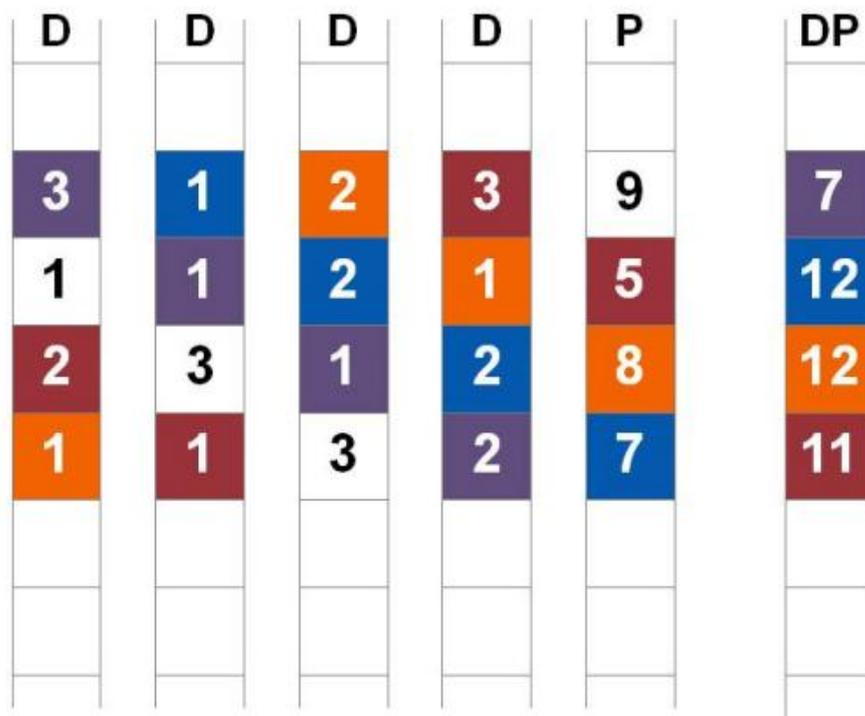
Рис. 3) Пример вычисления *diagonal parity*.
